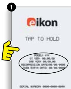
18.3.1 Установите новый ПМ, установите обратно кожух, включите печь, коснитесь экрана и удерживайте палец, чтобы проверить, соответствуют ли версии QTS и SRB (1) последнему выпуску. Если это не так, выполните обновление микропрограммного обеспечения и установите самые свежие версии. Подробные сведения см. в параграфе «Обновление микропрограммного обеспечения» (раздел «Техническое обслуживание»).
