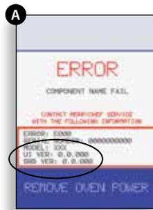
12.1.2 Сбросьте сообщение об ошибке путем отключения и подключения печи к сети электроснабжения (не с помощью выключателя печи).
